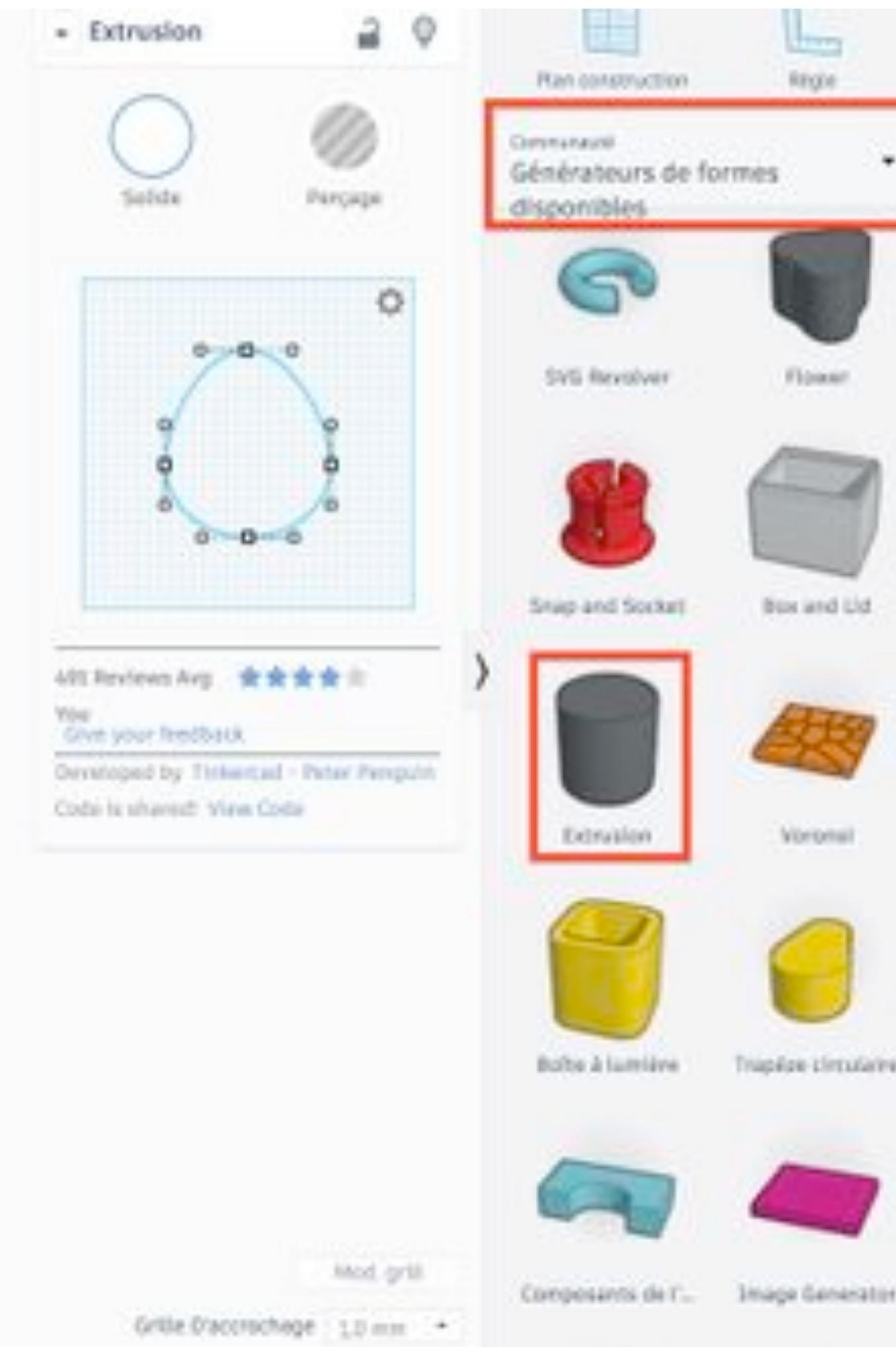
Construire le contour en utilisant l'outil extrusion
